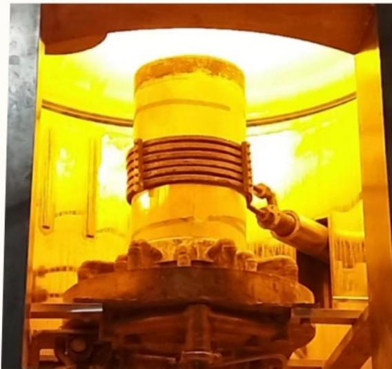
160千克规格氧化物冷坩埚熔融设备实图（氧化锆）
